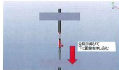
⑤配管貫通部 押し込み
